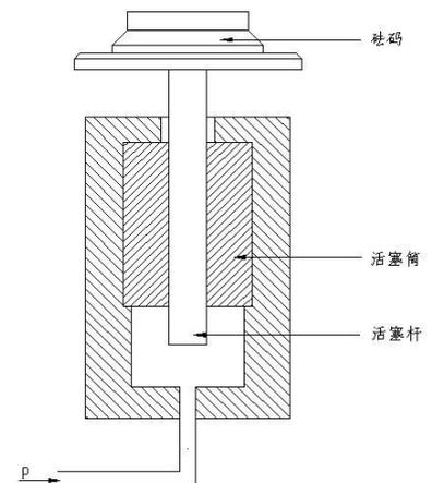
实际使用活塞压力计测量压力时，还须考虑其他因素的影响，如压力测量点至活塞低端的距离  $h$  引入的液（气）柱差修正项： $\rho_l gh$ ，当测量点高出活塞低端时  $h$  为负，反之为正， $\rho_l$  为测压介质密度；测量绝压时，还须引入真空罩中的参考真空  $P_r$ （测量表压时为零），故一般活塞压力计测量压力的表达式如下：
